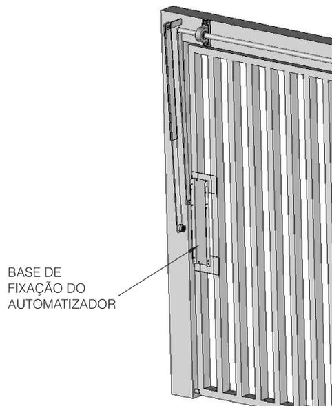
**4º Passo:** Fixe o automatizador na base do portão com parafusos.
