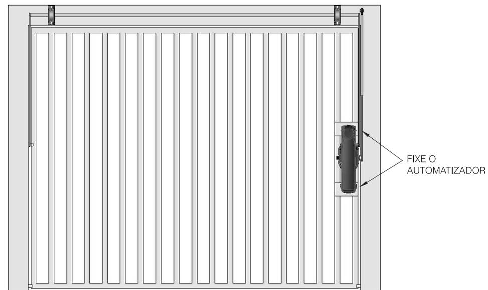
**5º Passo:** Posicione o apoio do conjunto da bainha na parte superior do portão e instale-o, através do parafuso, obedecendo a distancia de 110 mm entre ao final da folha do portão e o conjunto da bainha.
