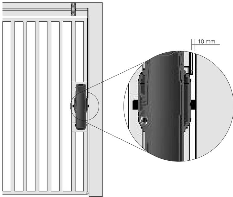
**3º Passo:** É necessário soldar ou fixar com parafusos a estrutura base do automatizador diretamente na folha do portão.
