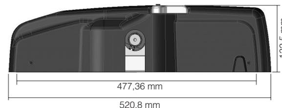
**1º Passo:** Posicione o automatizador sobre a folha do portão, tendo como referência a distância de 110 mm entre o eixo central do automatizador e o eixo da folha do portão.
