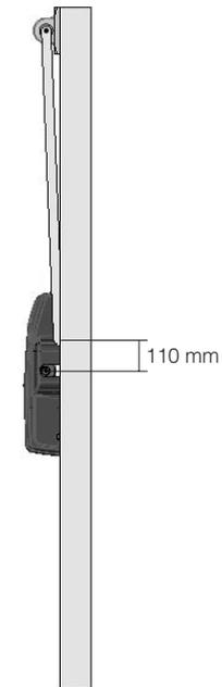
**2º Passo:** Verifique se a ponta do eixo do automatizador está posicionada a 10 mm fora da linha do braço de ligação do portão.
